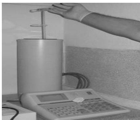
Figura 3. Calibrador de Dosis, marca Caprintec, modelo ACT01.
