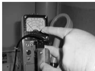
Figura 4. Monitor Geiger-Müller, marca Ludlum Measurement, Modelo 3A.
