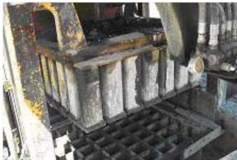
Figura 5. Dispositivo para la compactación de la mezcla durante la fabricación de tabicones
