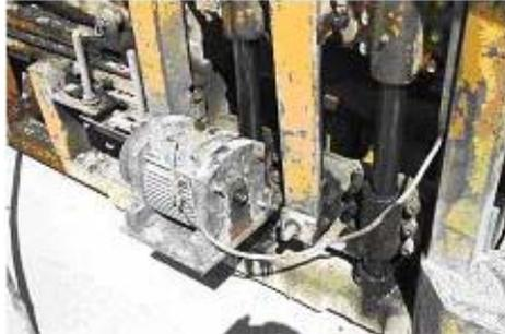
Figura 4. Equipo para vibración de la mezcla durante la fabricación de tabicones
