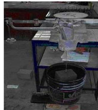
**Figura 11.** Inmersión de los especímenes para determinar el peso ahogado durante la prueba de absorción
