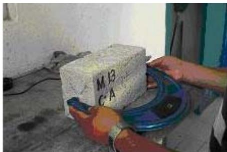
**Figura 9.** Medición de la longitud después del periodo de secado para la prueba de contracción
