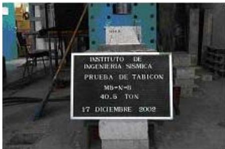
**Figura 8.** Ensayo a compresión axial de tabicones, mezclas sin curado
