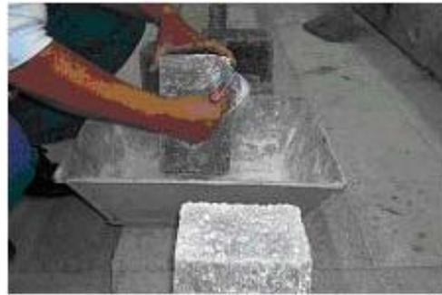
**Figura 10.** Impregnación de la superficie del tabicón para la prueba de peso específico
