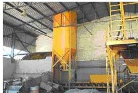
**Figura 2.** Equipo para la dosificación del cemento en las mezclas
