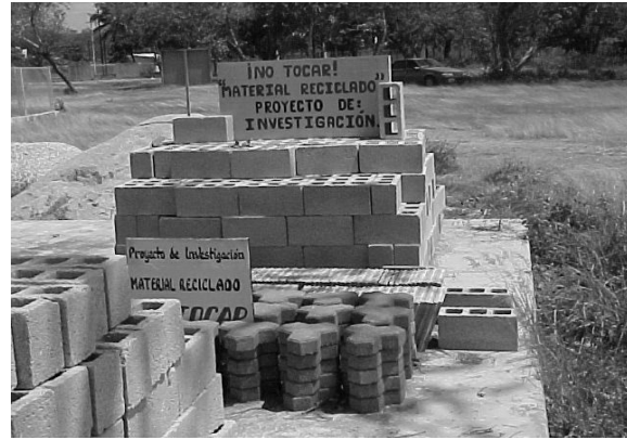
Figura 4. Elementos constructivos reciclados.
