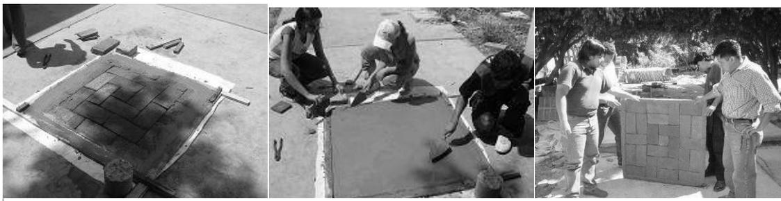
**Figuras 5,6, 7.** Parte del proceso de fabricación de una pieza de componente para techo Domotej, elaborado en instalaciones de la Facultad de Arquitectura de la Universidad Autónoma de Chiapas, México.
