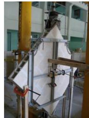
**Figura 3.** Vista general del ensayo de muretes de mampostería
