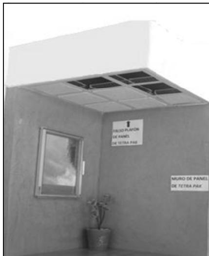
**Figura 2.** Aplicación del pentapanel en muro y plafón escala 1:3
