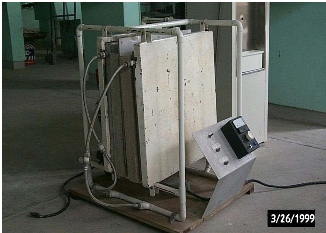
Figura 2. Sistema de placas y control con muestras de concreto
