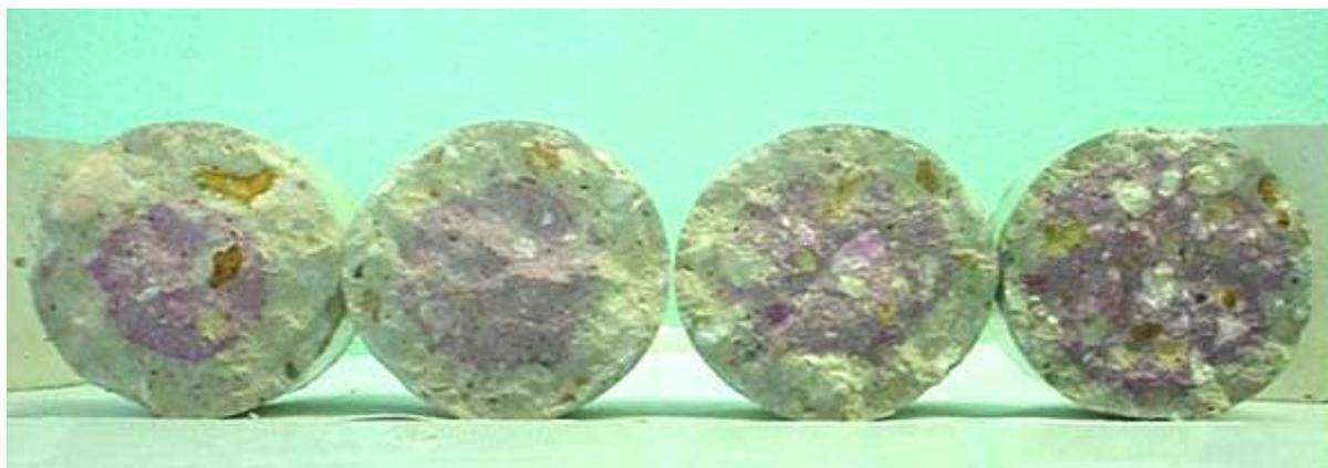
**Figura 8. Cilindros de concreto rociados con fenolftaleína al 1% para indicar la profundidad de carbonatación .**
