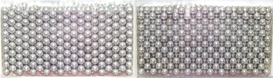
**Figura 5.** A la izquierda se aprecia una estructura BCT, caracterizada por un centro y seis vecinos; a la derecha se observa una estructura FCC, denotada por un centro y cuatro vecinos. Nótese como relucen los puentes líquidos entre las esferas (derecha).
