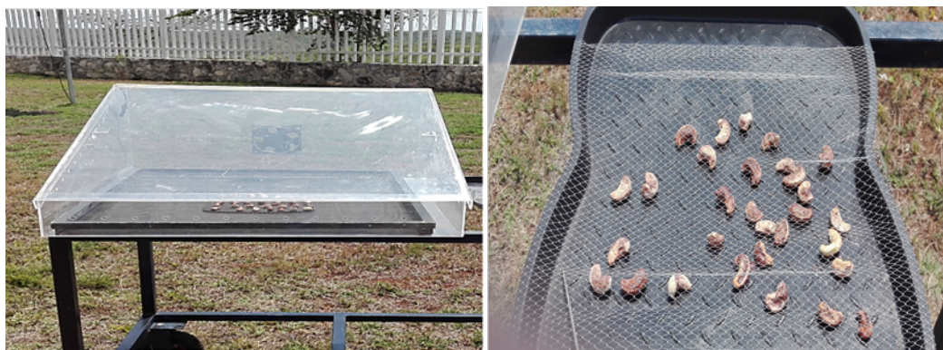
Figura 1 Secador solar directo tipo gabinete y secado a cielo abierto.
