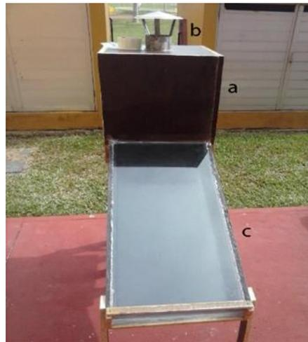
Figura 3 Secador solar indirecto. a) Cámara de secado, b) Chimenea y c) Colector de aire
