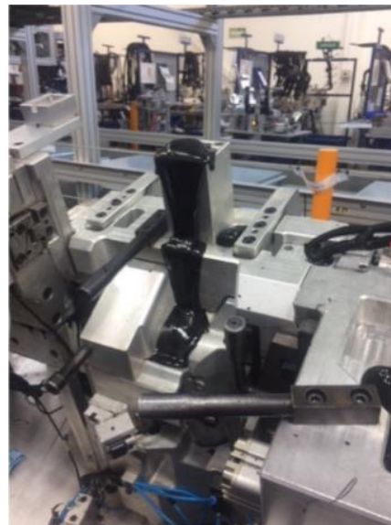
Figura 1: Derrame de material en punto de inyección
