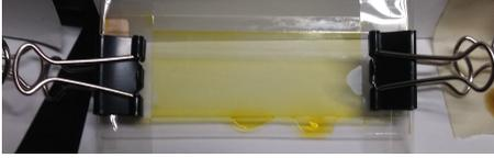
Figura 4: Celda fotosensible preparada para grabar una rejilla holográfica en ella.
