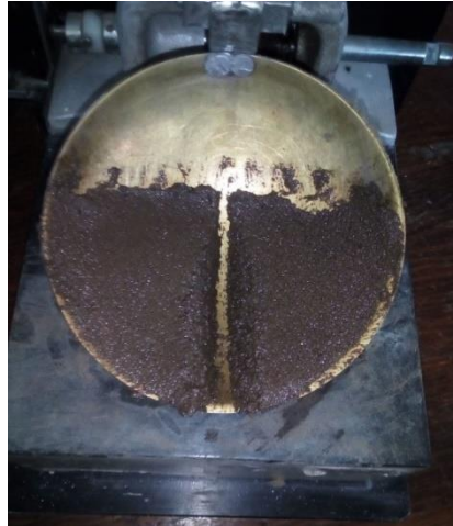
Figura 2. Ejemplo de la ranura para la realización del límite líquido.
