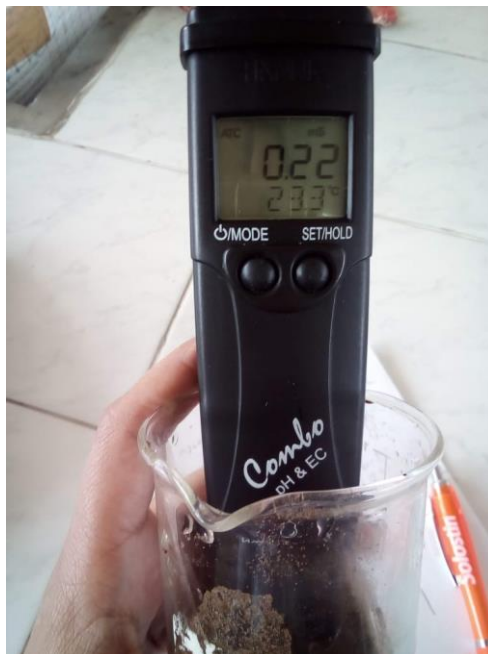
Figura 1. Medición del pH del suelo contaminado con el potenciómetro HANNA HI
