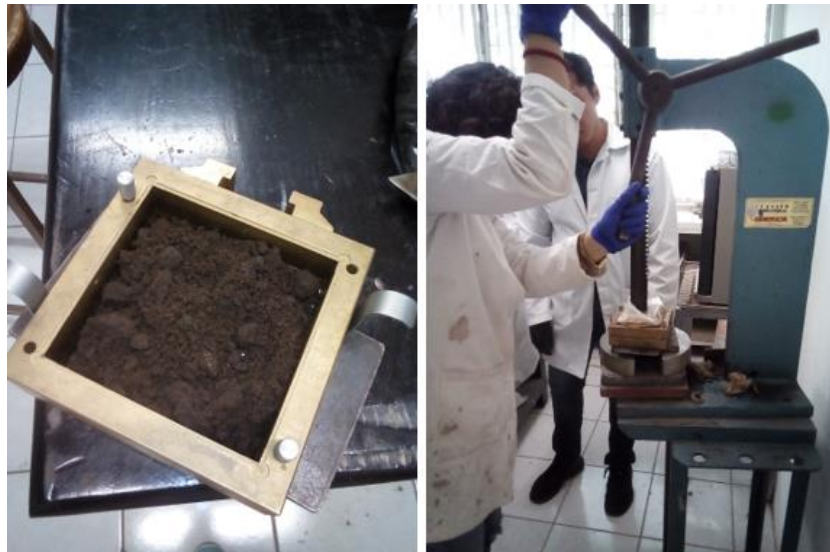
Figura 5. Creación de las muestras remoldeadas
