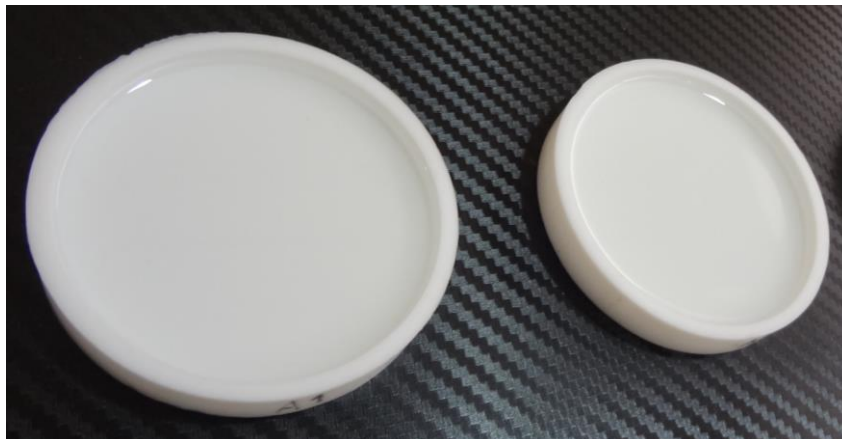
Figura 1. Moldes de teflón utilizados para la síntesis de las membranas.
