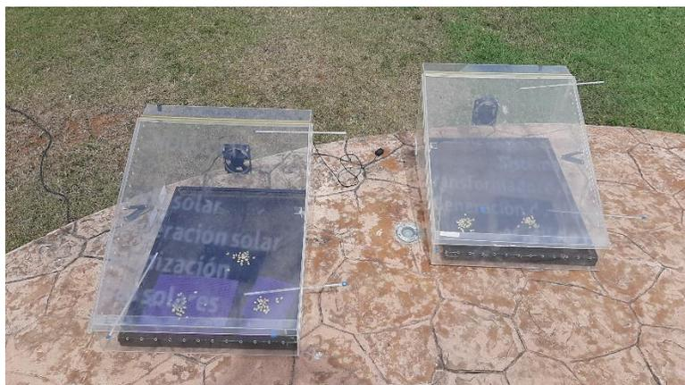
**Figura 1** Secadores solares de gabinete con convección natural y forzada.
