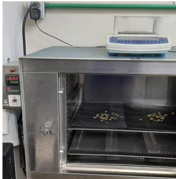
**Figura 2 Horno eléctrico digital Riossa®**
