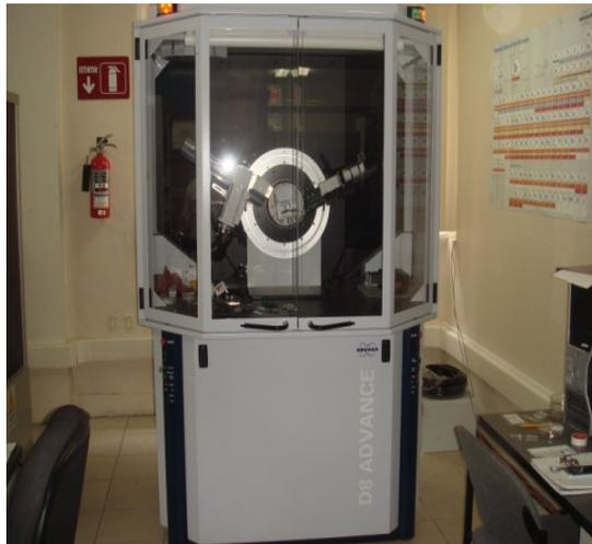
Figura 5. Fotografía del difractómetro.
