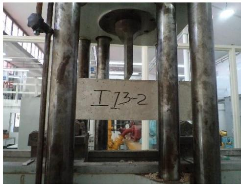
**Figura 5.** Ensayo a flexión de especímenes prismáticos
