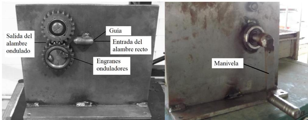
**Figura 1.** Mecanismo ondulator para alambre
