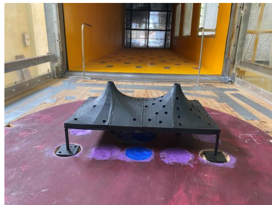
Figura 5: Modelos a escala en la cámara de ensayos
