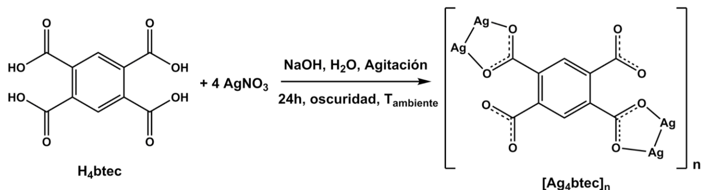
Esquema 1. Reacción de formación del MOF [\text{Ag}_4\text{btec}]_n .
