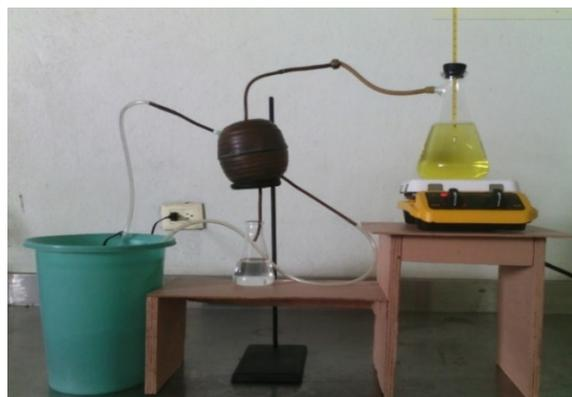
Figura 3. Sistema rústico de destilación de alcohol utilizado.
