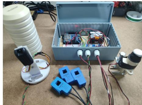
Figura 5: Sistema de adquisición de datos.
