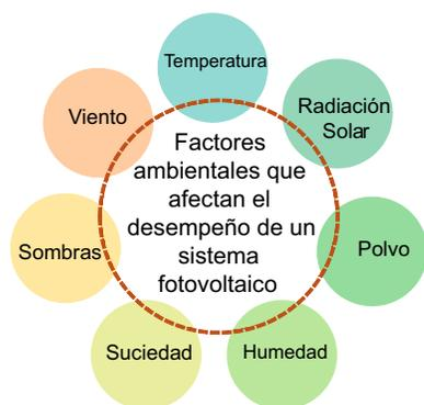
Figura 2: Factores ambientales que afectan el rendimiento de un sistema fotovoltaico.
