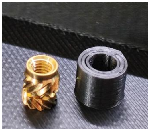
Figura 31. Injerto metálico con la zona donde será colocado por medio de calor.
