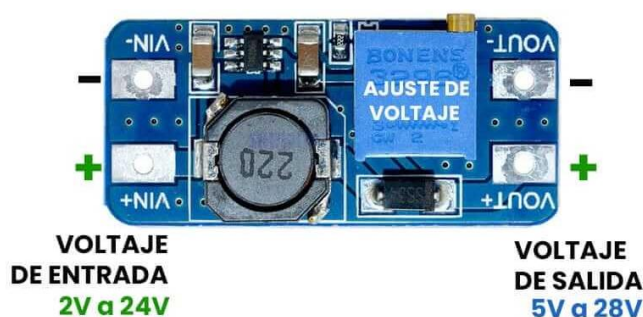
Figura 7. Módulo elevador de tensión MT3608 [8].
