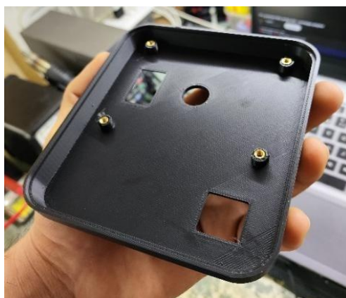
Figura 32. Injertos metálicos instalados.
