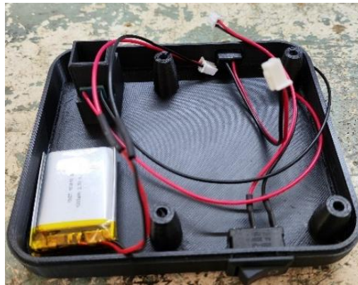
Figura 29. Conexiones eléctricas dentro del chasis.
