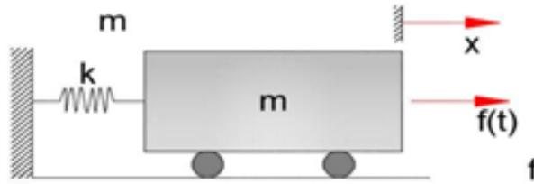
Figura 2. Modelo matemático de un grado de libertad.
