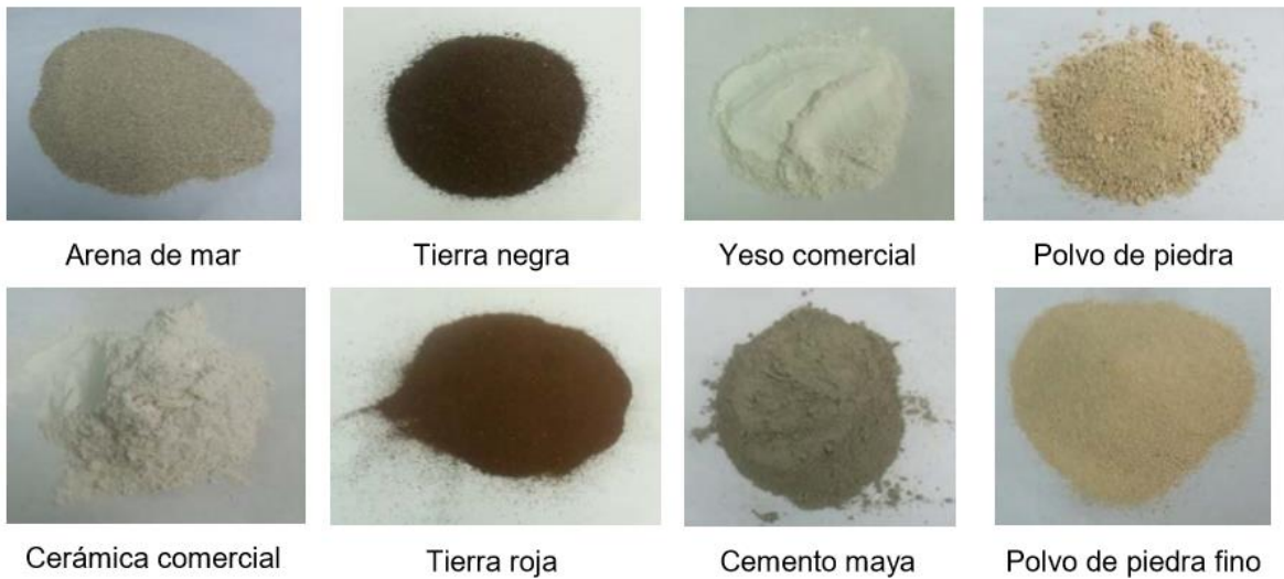
Figura 4. Muestras de los diferentes materiales en polvo a quienes se midió el valor de la conductividad térmica k .
