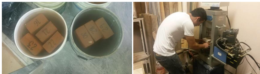
Figura 6.- Prueba de absorción y de resistencia a la compresión.
