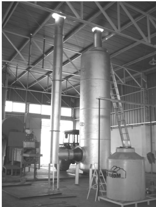
**Figura 5.** Fotografía de la torre lavadora de gases.
