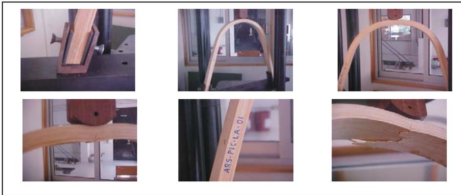
Figura 9. Etapas durante la prueba de flexión con arcos en posición vertical
