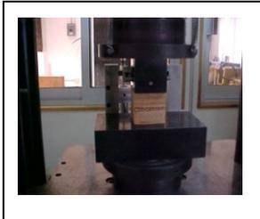
Figura 3. Algunos aspectos de la prueba de compresión perpendicular a la fibra
