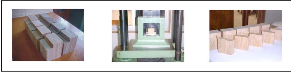
Figura 2. Algunos aspectos de la prueba de cortante paralelo a la fibra
