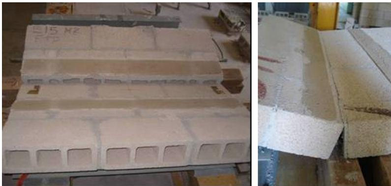
**Figura 5.** Falla típica por adherencia bloque-mortero (perpendicular a las juntas)
