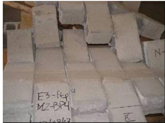
Figura 7. Falla típica por adherencia bloque-mortero (paralela a las juntas)
