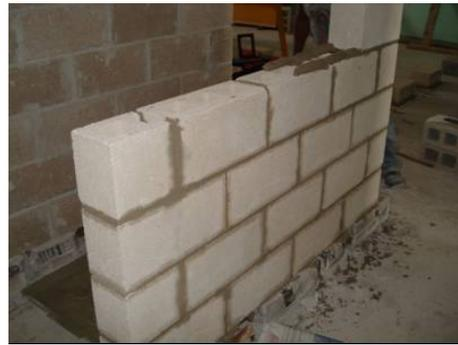
**Figura 1.** Construcción de especímenes
