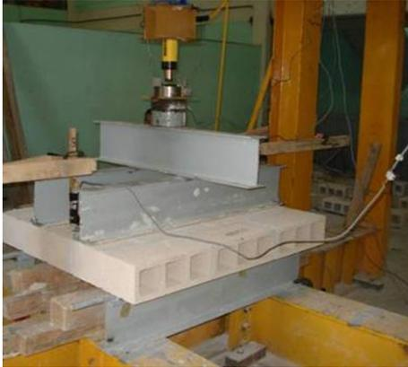
**Figura 2.** Vista general del ensaye de muros de mampostería
