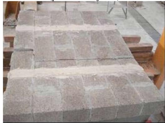
La falla típica por adherencia bloque-mortero y la falla típica combinada adherencia bloque-mortero y tensión de bloques de los especímenes se presentan en la Figura 7 y , respectivamente.
