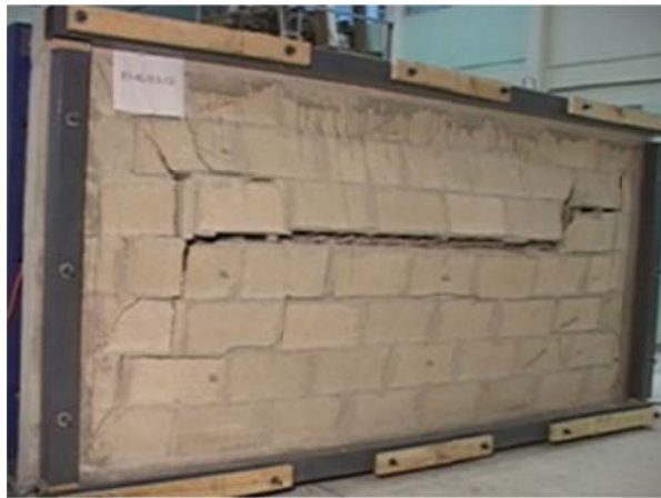
Figura 12. Vista del espécimen E-1 antes de colapsar
