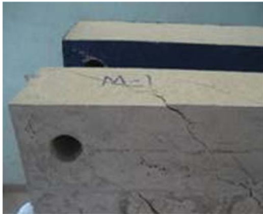
Figura 14. Agrietamientos en uniones dala – castillo
