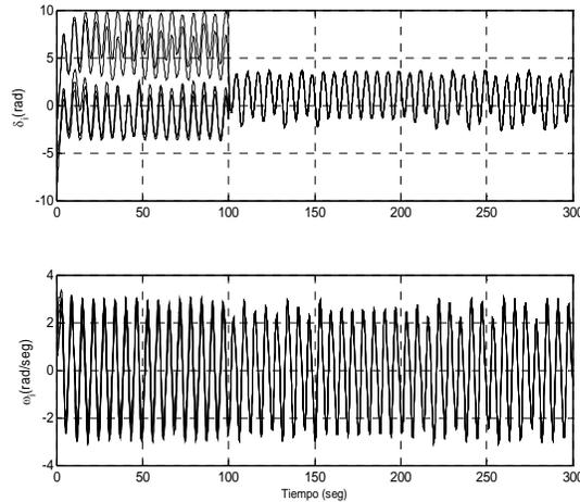
**Figura 2.** Evolución de los estados de los sistemas de la red,  $\delta_i$  representa las posiciones angulares de los generadores y  $\omega_i$  la velocidad angular.
