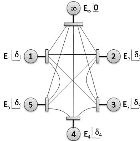
**Figura 1.** Red de sistemas de potencia como generadores conectados con el bus infinito.
