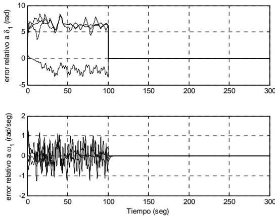
**Figura 3.** Errores de posición y velocidad relativos al generador 1.
